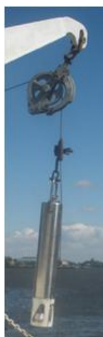
Рисунок 4.4 – Гидрологический зонд ОЛД-1. Пример использования
