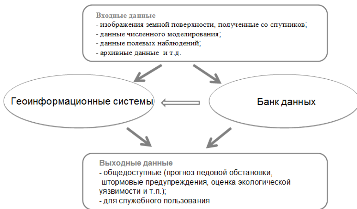
Рисунок 2.12 - Принципиальная схема системы прогнозирования гидрофизических характеристик
