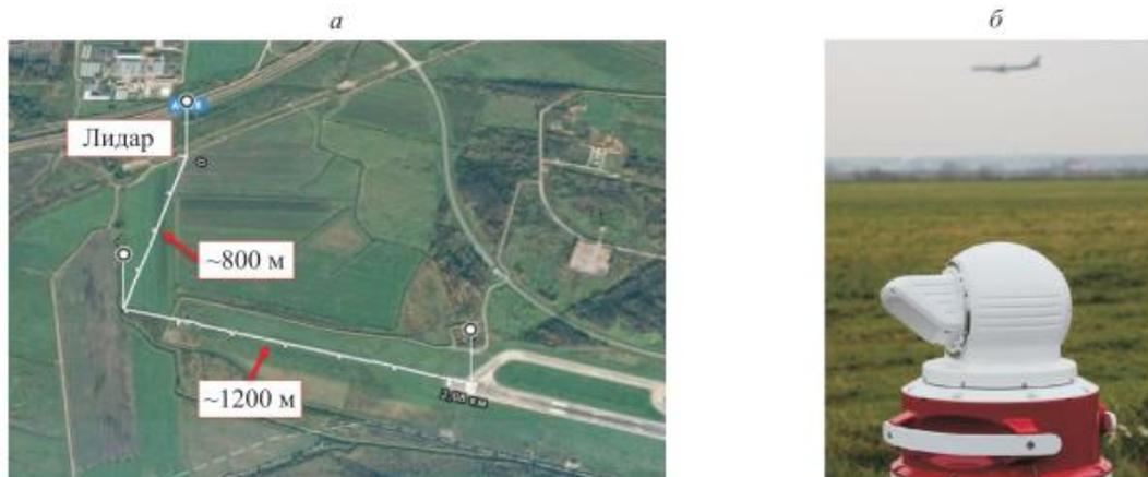
Рисунок 12 Схема расположения лидара (б) относительно ВПП (а) и его внешний вид.
