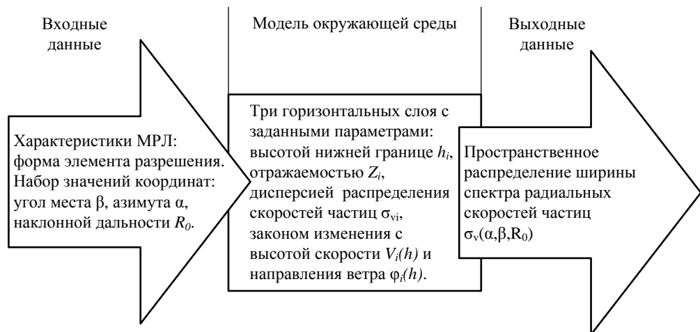
Рис. 4. Блок-схема модели сдвига ветра при наблюдении его метеорологическим радиолокатором
