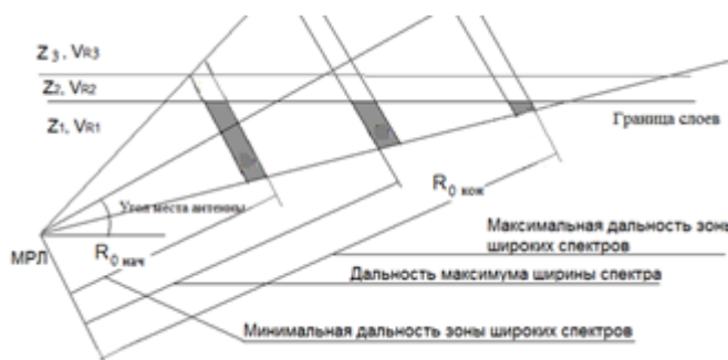
Рисунок 8 - Схема формирования вертикального распределения ширины спектра принимаемого сигнала
