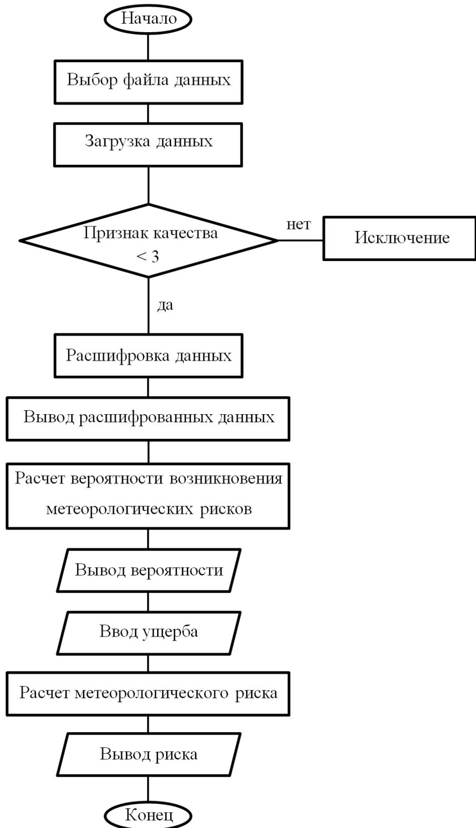
Рисунок 66 – Блок-схема разработанной методики оценки риска с помощью программного решения
