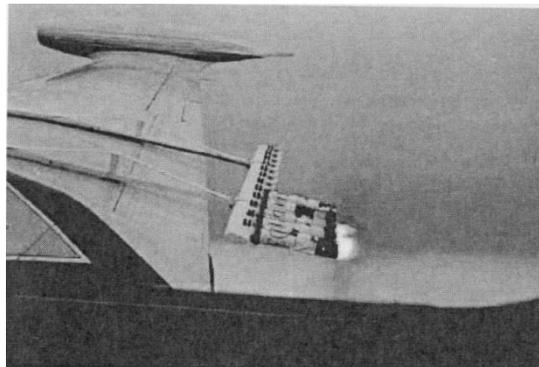
Рисунок 1.15. Самолетные пиротехнические аэрозольные генераторы, установленные на крыле самолета
