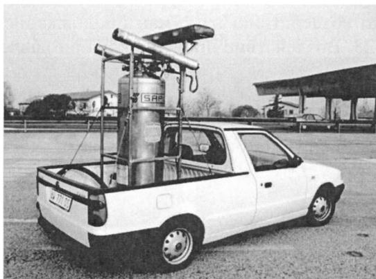
*Рисунок 1.8. Общий вид мобильного жидко-азотного генератора*
