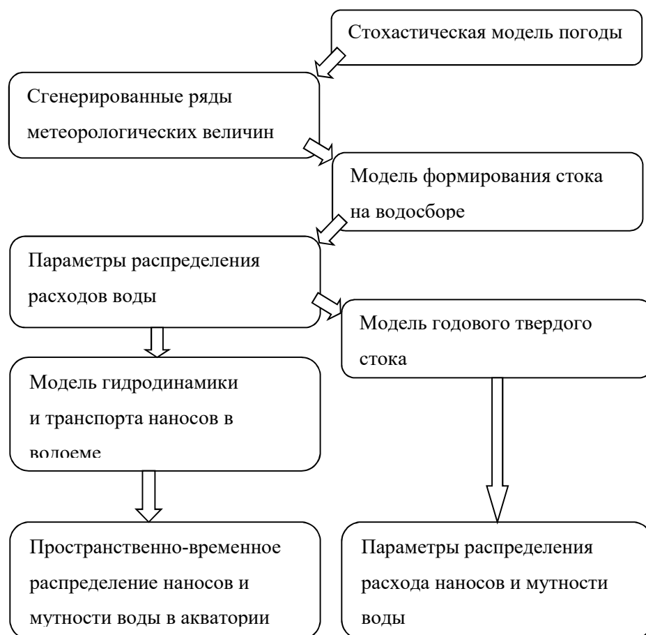
Рисунок 3.14 – Схема детерминированно-стохастической моделирующей системы IL_DSM для количественной оценки и прогнозирования массопереноса в системе «водосбор – водный объект»
