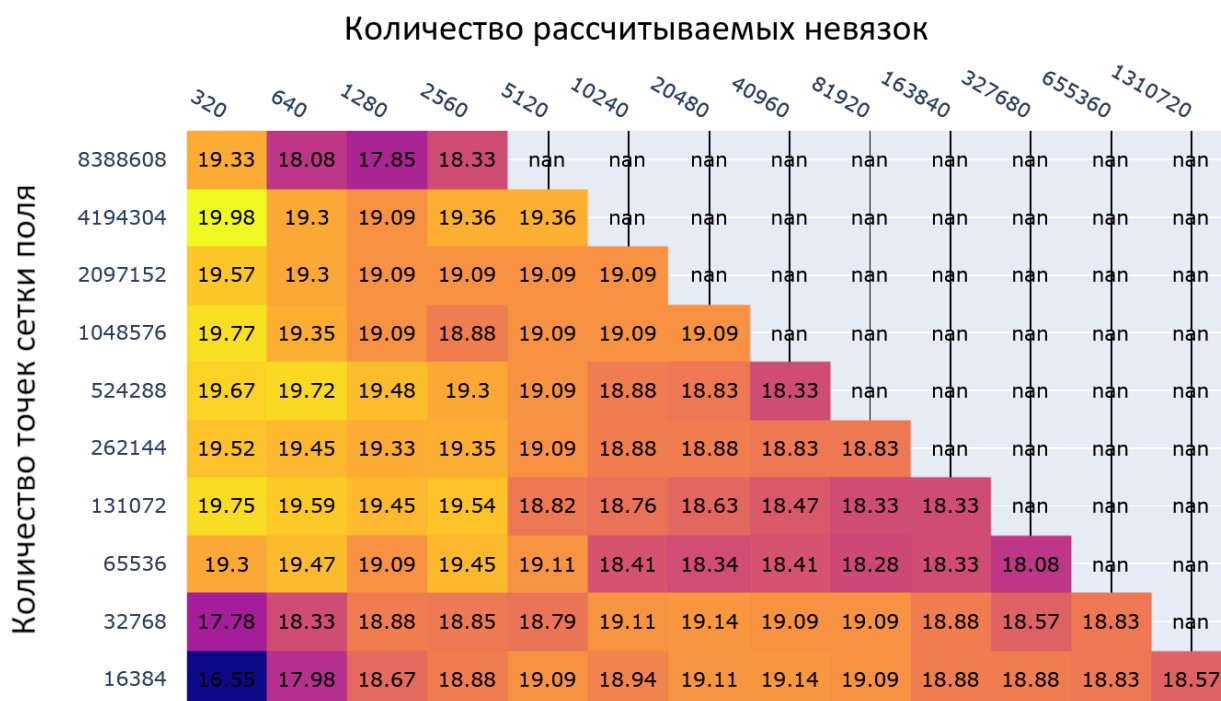
Рис. 4.22. Производительность графического ускорителя GeForce 1650 GT.
