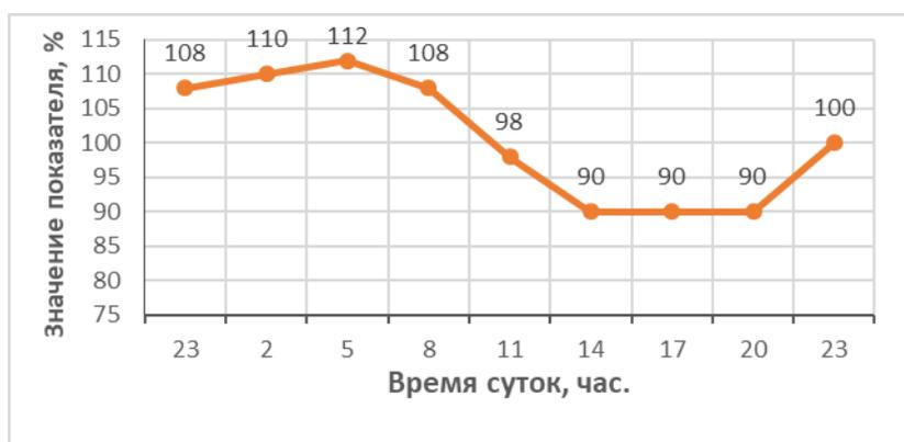
Рисунок 5.10 — Динамика изменения хлорпоглощаемости в течение суток
