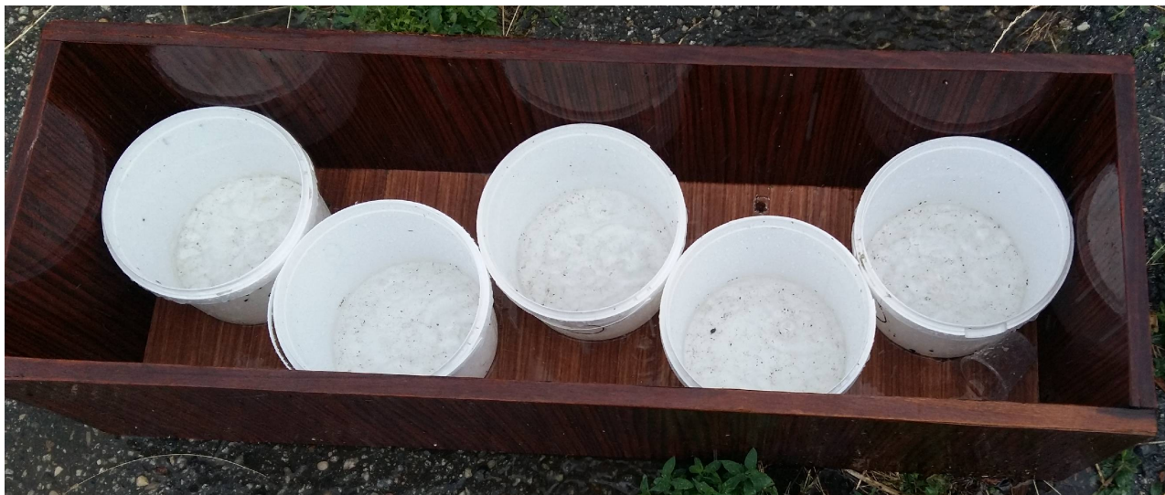
Рис. 5.6 Осадкосборники в ветрозащитном укрытии
