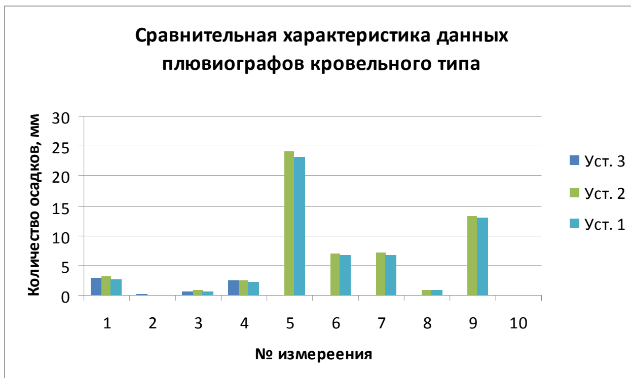
Рис. 5.14 Сравнение количества осадков, измеренных с помощью экспериментальных установок кровельного типа
