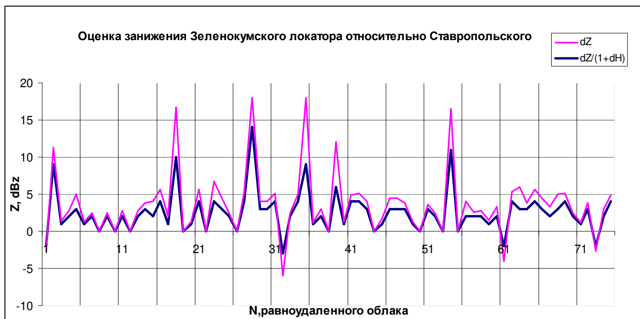
Рис. 3.10. Разница в значениях максимальной отражаемости dZ (розовая кривая) и его отношения на параметр высоты (синяя кривая) равноудаленных облаков, измеренных эталонным и поверяемым лоаторами по данным за 2010 г.
