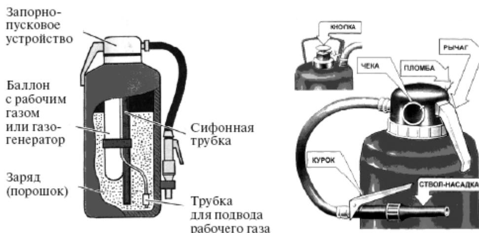
Рис. 11. Порошковый огнетушитель со встроенным газовым источником давления ОП-5
