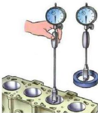
Рис. 2.4 Измерение внутреннего диаметра
