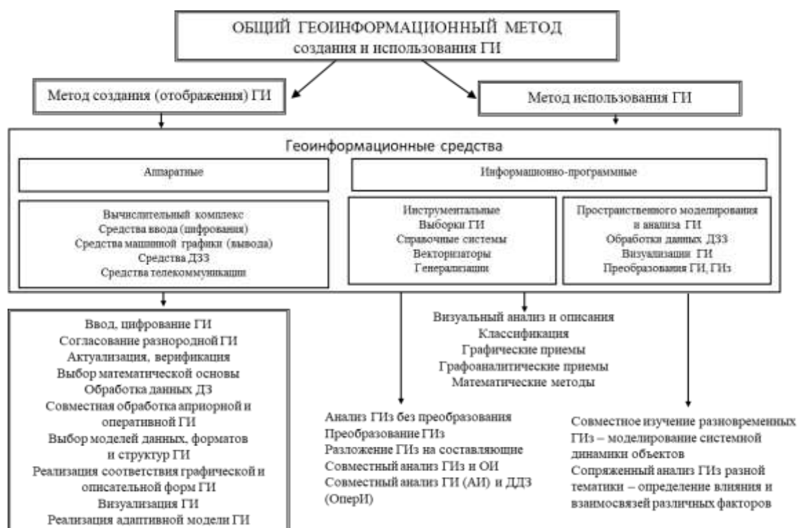
Рисунок 68 — Структура общего геоинформационного метода отображения и использования ГИ: ДЗЗ – данные зондирования Земли; ОперИ – оперативная информация; АИ – априорная информация; ОИ – описательная информация
