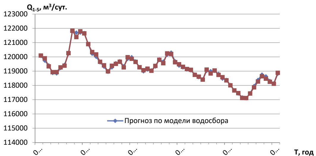
Рисунок 2.21 – Прогнозные и фактические значения среднемесячного водопритока к карьере, вскрывшему палеозойские отложения, при коэффициенте b=f(Q_{\text{вод}})
