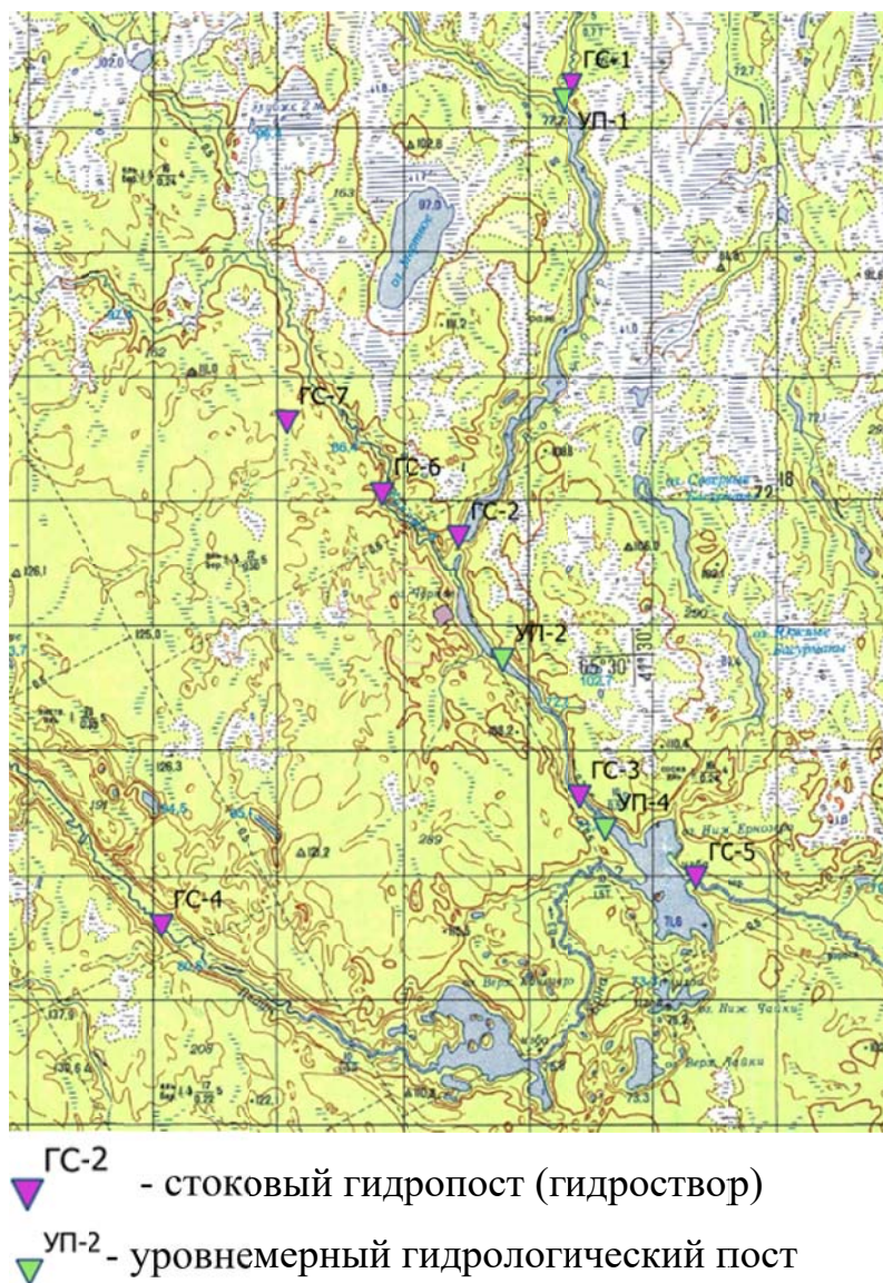
Рисунок 4.1 – Схема расположения гидростворов и уровенных постов в районе месторождения им. В.П. Гриба
