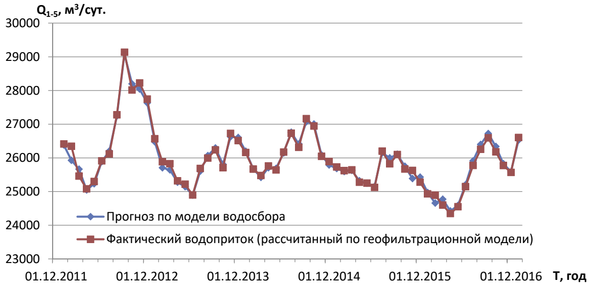
Рисунок 2.20 – Прогнозные и фактические значения среднемесячного водопритока к карьере, вскрывшему четвертичные отложения, при коэффициенте b=f(Q_{\text{вод}})
