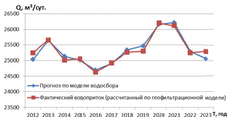
Рисунок 2.16 – Прогнозные и фактические значения годового водопритока к карьеру, вскрывшему четвертичные отложения, при коэффициенте b=f(Q_{вод})
