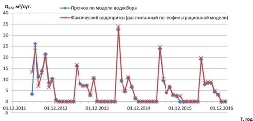
Рисунок 2.28 – Прогнозные и фактические значения среднемесячного водопритока к карьере, вскрывшему четвертичные отложения, при коэффициенте
