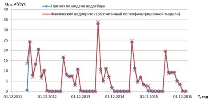
Рисунок 2.26 – Прогнозные и фактические значения среднемесячного водопритока к карьеру, вскрывшему четвертичные отложения, при постоянных коэффициентах модели
