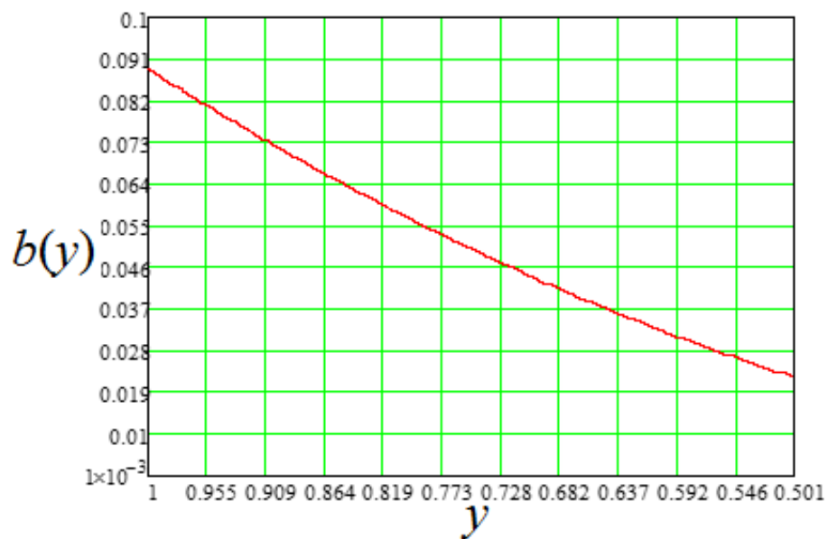
Рис. 3.6. Зависимость энергии турбулентных пульсаций b(y) от высоты. Регион Герегу, март (Сухой сезон) [40]
