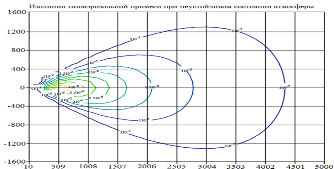
Рис. 3.15 а. Уровни поверхностного загрязнения подстилающей поверхности для неустойчивого состояния атмосферы при L = -5 , z = 1,5 м, [65]
