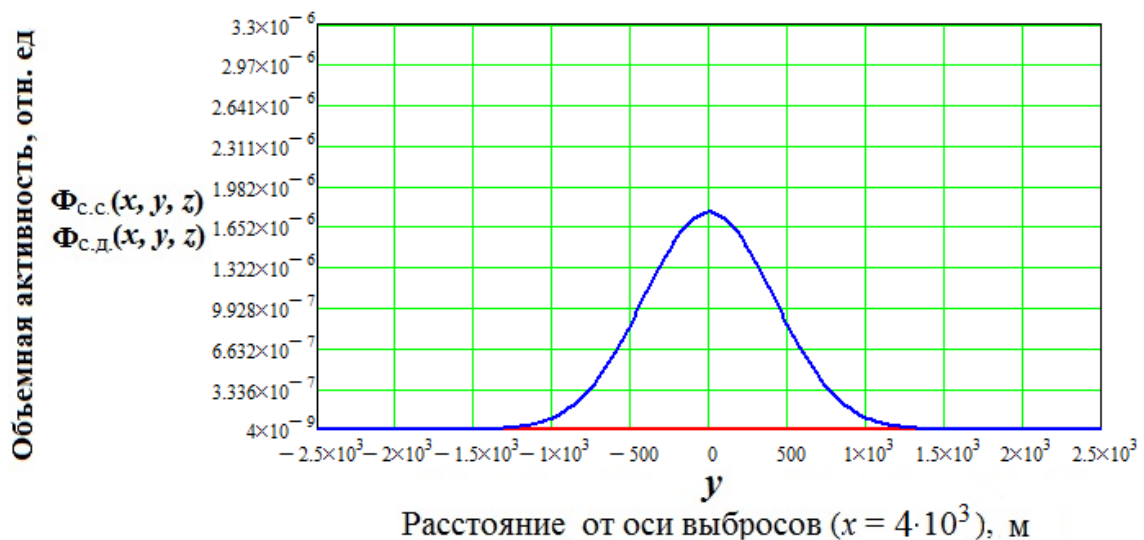
Рис.3.13. Поперечные распределения объемной активности в регионах Герегу, март (1, сухой сезон, \sigma_0 = 0 ) и Иту, апрель (2, сезон дождей, \sigma_0 = 0,57 \cdot 10^{-5} ); z = 1,5 м [40]
